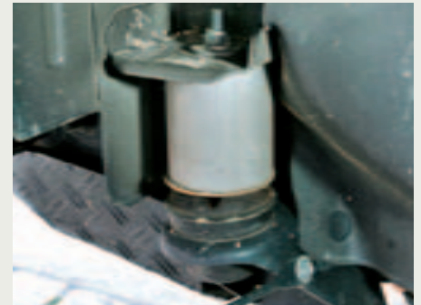
Geliftet: Distanzstücke für die Karosserie bringen acht Zentimeter mehr.
