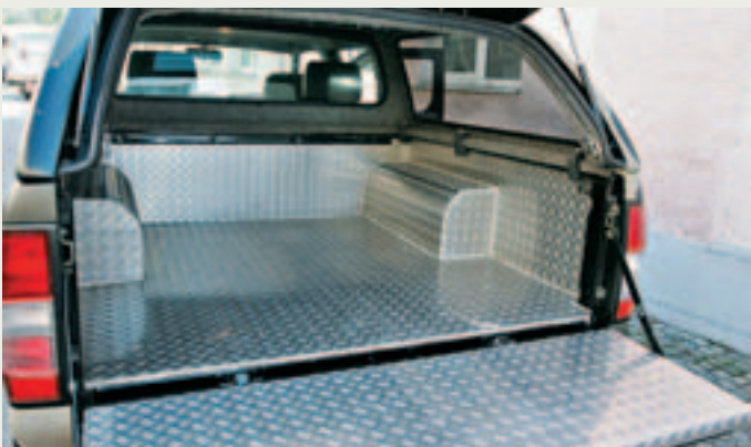
Maßarbeit: Edle Laderaum-Auskleidung mit Alu-Riffelblech.
