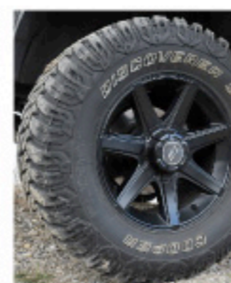
Offroad-Ehe: 8x17-Alufelge Typ CWE von CW-Fahrzeugtechnik plus Cooper Discoverer STT in 33x12.50 R 17.
